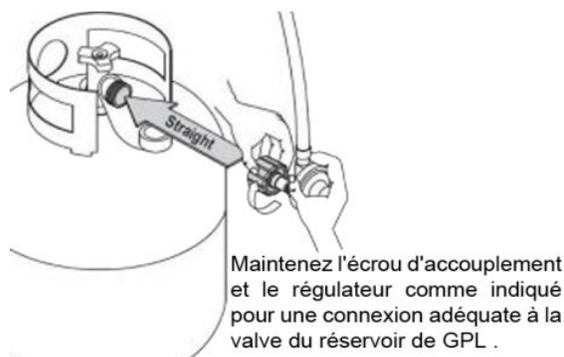
Lors du raccordement du régulateur à la vanne du réservoir, assurez-vous que l'écrou d'accouplement ne fait pas de filetage croisé sur la vanne du réservoir. Le filetage croisé de l'écrou du régulateur sur la vanne du réservoir peut provoquer une fuite.
